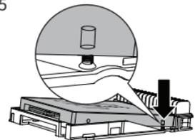
将硬盘前端向下按压, 使其与托盘上的内置螺丝对齐。确保螺丝稳固地卡入硬盘。
