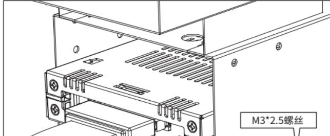
4-1. 将 MB741V4P-B 插入标准 3.5 英寸软驱位, 并使用自带的 4 颗 M3\*2.5 螺丝将设备固定在软驱位上。
