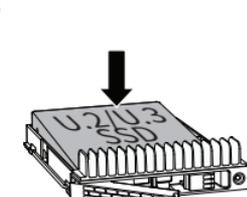
用力按下硬盘的后端, 将硬盘牢固固定在托盘上。
