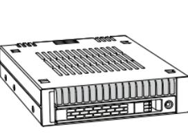
▼ Express 托盘支持免工具安装硬盘。托架内部的专利机械设计可在 ExpressTray 插入机箱后将硬盘牢牢固定。为防止硬盘掉落, 请勿在托盘上放置 HDD 或 SSD 时将 Express 托盘倒置。
