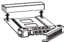
拧松2颗M3\*4螺丝拆下塑料支架，保留螺丝用于硬盘的安装。
