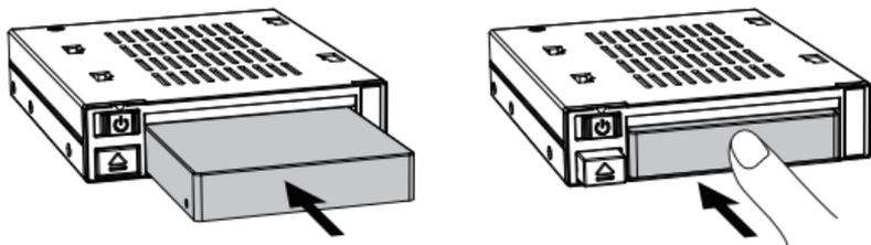
2. 拆卸2.5英寸U.2 SSD-按下硬盘弹出按钮，弹出2.5英寸U.2 SSD，然后将其从插槽中拉出。
