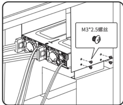
2. 将设备插入机箱内5.25英寸托架, 并使用附带的M3\*2.5螺丝固定设备。
