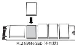
如果M.2硬盘上的组件之间存在显著的高度差,则去除保护膜,然后将小块热垫粘贴到较短的组件上,以实现完全接触。
