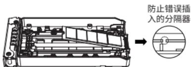
为防止M.2SSD盘定位错误,请将M.2SSD盘接口上的缺口对准硬盘托架后的金属销钉。然后将M.2 SSD盘插入孔位,露出SSD盘的金手指接口
