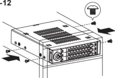
请使用附带的M3\*4螺丝将设备固定到3.5英寸装置空间托架上。
