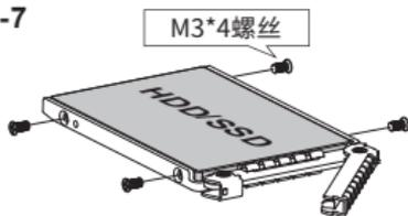
用附带的4颗M3\*4螺丝(两个用于拆卸ABS支架的螺丝)固定硬盘。
