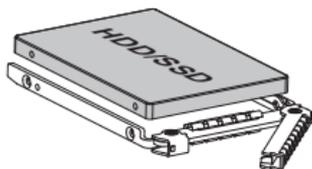
按下2颗M3\*4螺丝, 拆下ABS支架, 并保留螺丝, 以便安装硬盘 (3-7)。
