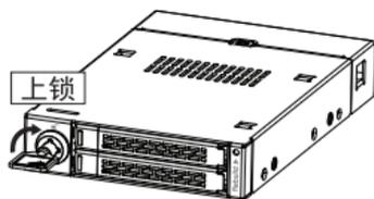
完成硬盘安装并选择想要使用的RAID模式后(注意:产品预设为JBOD模式,如果要切换RAID模式,请参考第4单元-RAID设定),将产品装入机箱,使用固定设备的螺丝将设备固定后,同时使用SATA 7Pin与15 Pin供电线连接装置及计算机。
