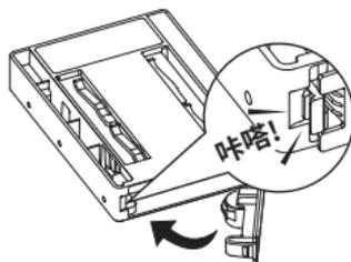
可选-两颗3\*4螺丝可以安装在托盘的底部, 以提高硬盘的稳定性
