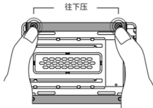
从设备的底部，按下两侧，打开散热器盖的锁扣。
