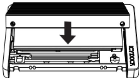
将拆卸下来的散热器盖放回原处。
