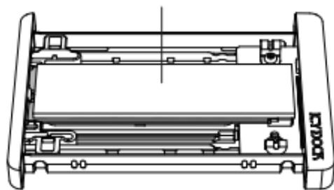
将散热垫粘贴到M.2 SSD硬盘上。
