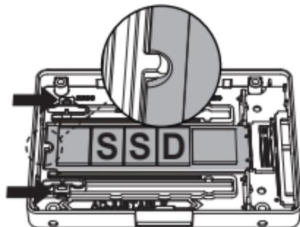
按住M.2 SSD硬盘的同时，将可调节固定器的两侧同时推入锁扣中。
