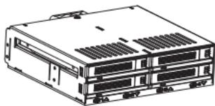
注意：硬盘托盘支持无工具安装。一旦硬盘托盘被插入设备内，设备内部的专利机械设计将完全保护硬盘。为了防止损坏您的硬盘，请不要在有硬盘的情况下将硬盘托盘颠倒。
