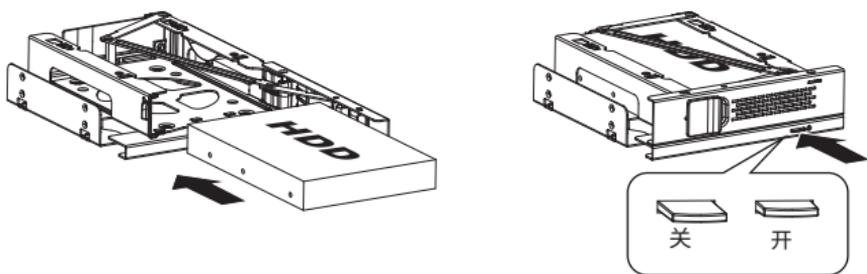
3. 请使用附带的M3\*6螺丝将设备安装到机箱内5.25英寸的托架中。将7Pin SATA和15Pin电源接口连接到设备以完成安装。
