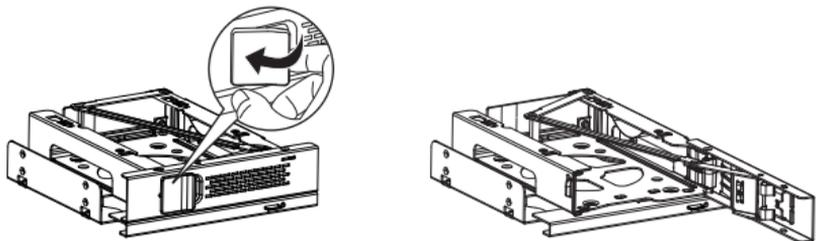
2. 确保硬盘接口处于正确位置，然后插入硬盘。关闭前门并按下电源按钮以打开设备。
