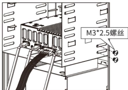
为了保证设备在硬盘插入和拆卸时的稳定性,请在机箱的两侧安装两个螺丝,如上图所示。
