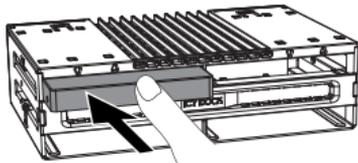
2. 移除2.5英寸硬盘-拔出硬盘的边缘,如下图所示。
